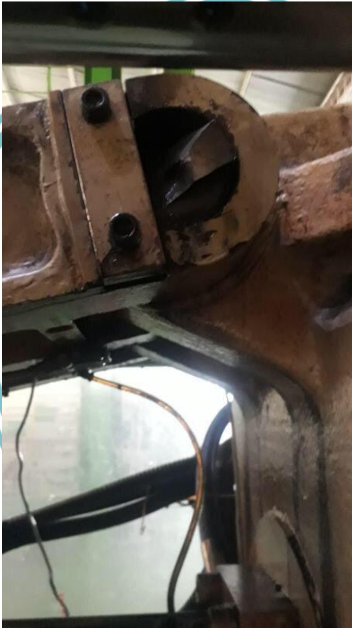
Lampiran 1 Posisi Actual Kerusakan Pin Toggle Clamping Unit
