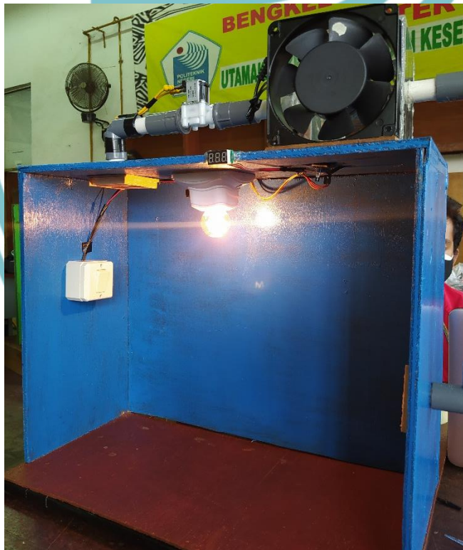
Gambar L. 23 Tampak Miniatur Fan Coil Unit
