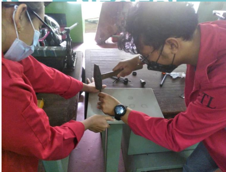
Gambar L. 13 Proses Penitikan Panel sebelum Pengeboran
