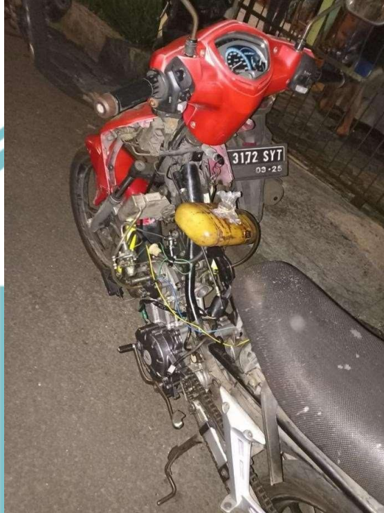
Gambar : Hasil Pembuatan Fuel system Type Mechanical Pada Prototype Engine Gasoline Ke Engine Diesel
