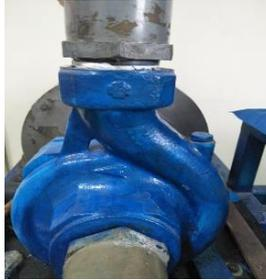
Gambar 4. Pompa sentrifugal sebagai Turbin
