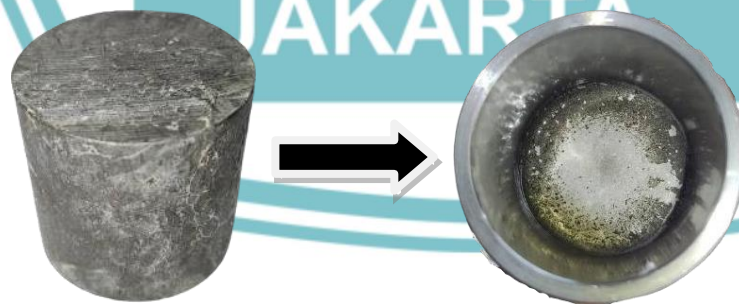
Gambar 1. 2 Hasil Proses Tempa Dingin
