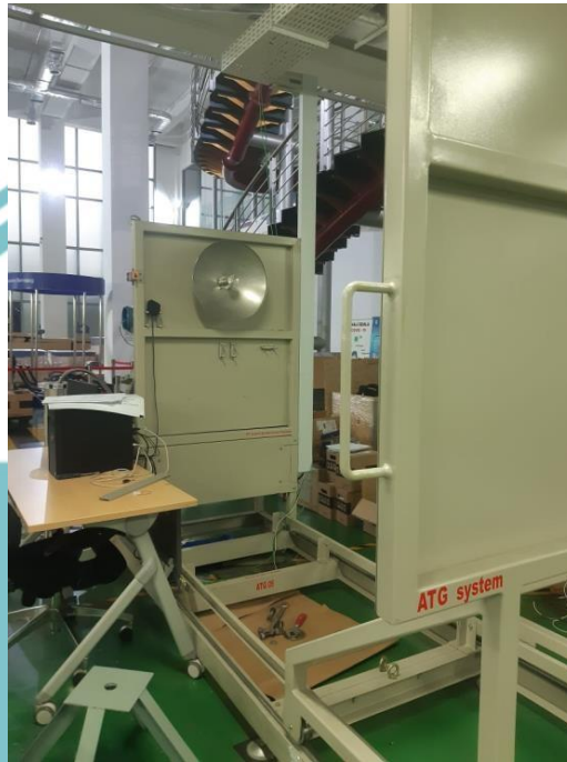
Gambar 1. 1 Alat Demo Automatic Tank Gauging yang ada diperusahaan
