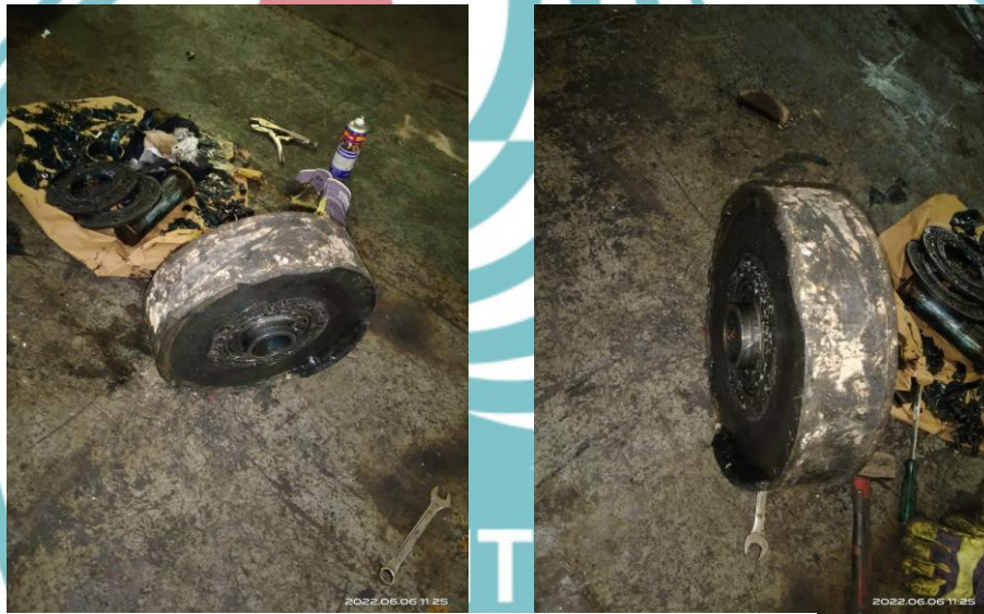
Gambar 1.1.1 Kerusakan Roda Harrow
