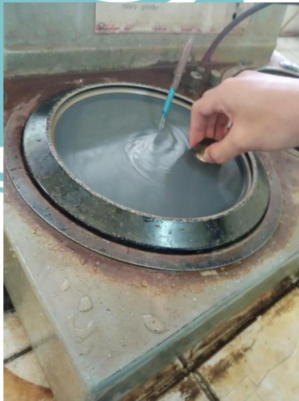
Lampiran 3: Proses Penghalusan Spesimen Uji Mikroskopis Baja ST 60
