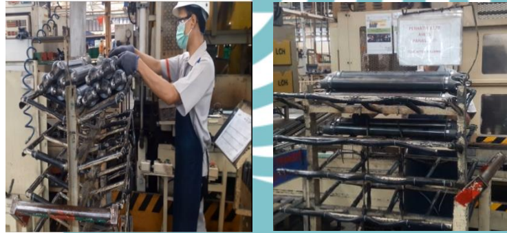
Gambar 1.4 Susunan Propeller shaft pada dolly
