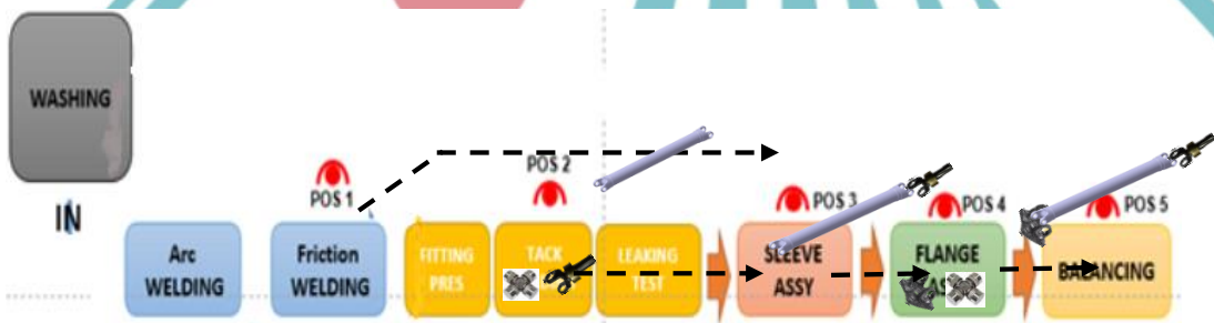
Gambar 1.2 Aliran proses produksi ideal pada lini produksi propeller shaft .
