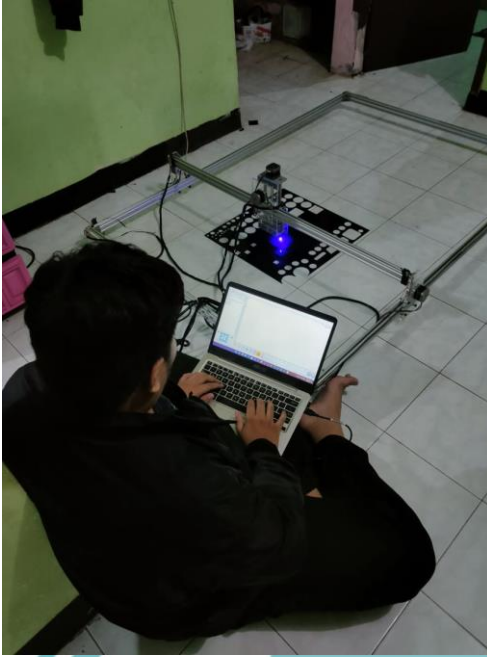
Gambar L.4 Pengujian Gerakan Gantry
