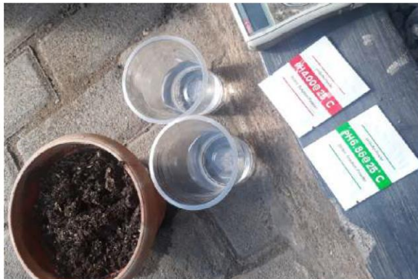
Gambar 8. Sampel Tanah dan Larutan PH Buffer Asam-Basa
