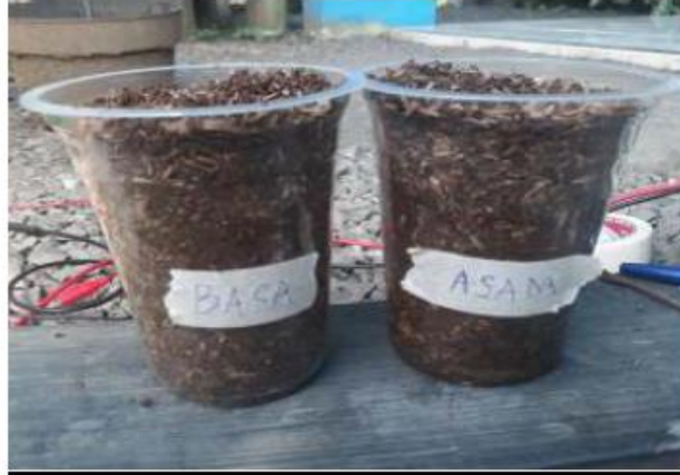
Gambar 9. Sampel Tanah yang sudah diberi larutan buffer Asam-Basa
