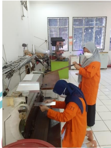
Pemotongan Plat Aluminium
