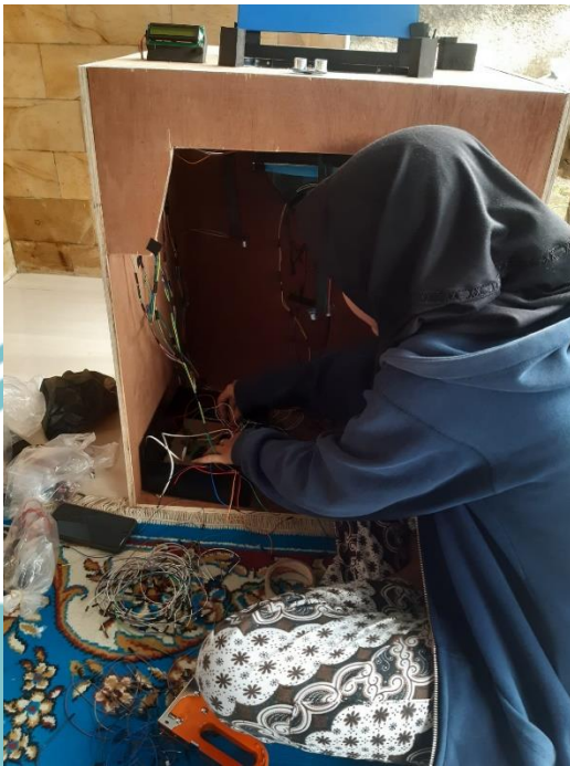
Pemasangan Jumper ke Mikrokontroler
