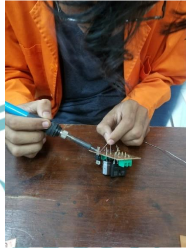
Melakukan Penyolderan PCB
