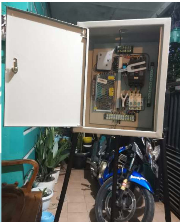
Lampiran 2. Foto Prototipe Pengendali MCCB dan MCB PHB-TR pada Simulasi Banjir Berbasis Internet of Things (IoT)
