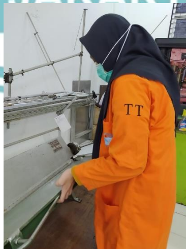
Proses membengkokan plat untuk heatsink
