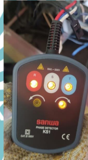
Gambar 3. 79 Pengecekan arah putaran fasa
