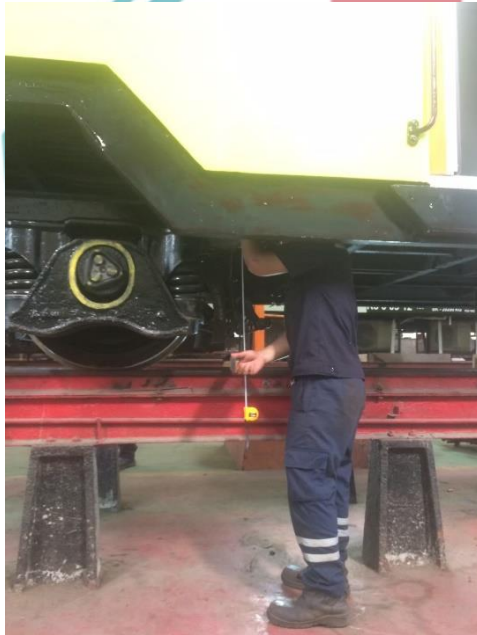
Gambar 1.2 (a) Pengukuran pada titik bogie kereta Gambar 1.2 (b) Pengukuran pada titik bodi kereta
