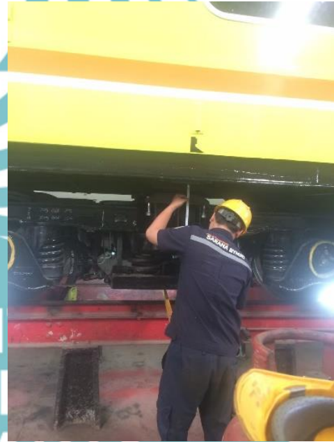
Gambar 1.2 (a) Pengukuran pada titik bogie kereta Gambar 1.2 (b) Pengukuran pada titik bodi kereta
