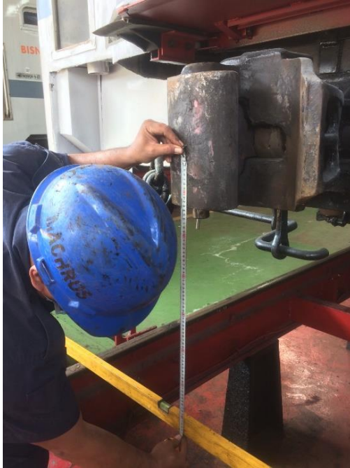
Gambar 1.3 (a) Pengukuran boffer kereta (penyambung kereta)
