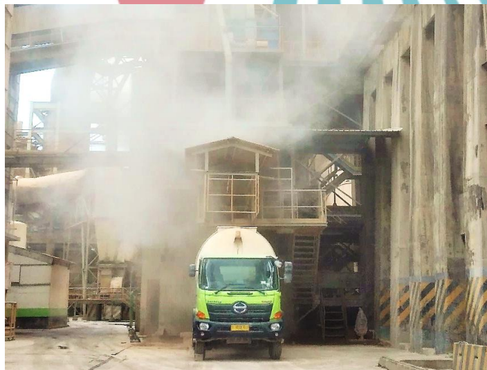
Gambar 1. 1 Proses Pengisian CKD ke Dalam Truck Bulk yang Menyebabkan Polusi Udara
