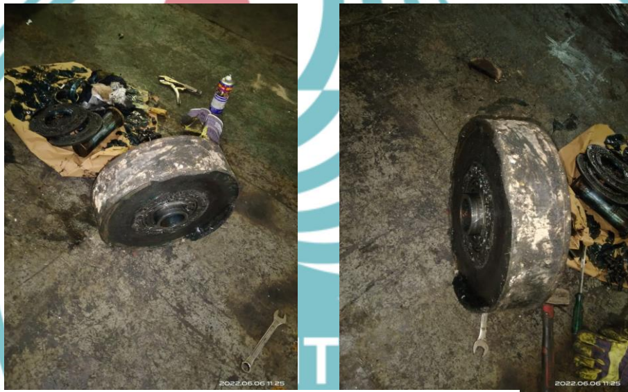
Gambar 1.1.1 Kerusakan Roda Harrow
