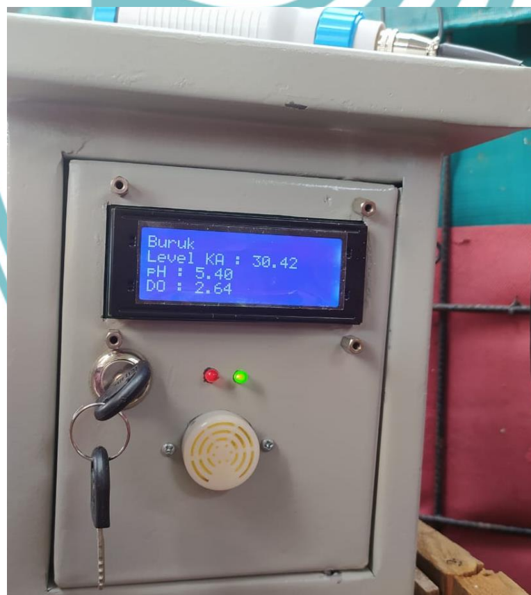
Foto 5. Hasil Level Kualitas Air dan Kualitas Air pada tampilan LabVIEW saat pH 5,40 dan DO 2,64
