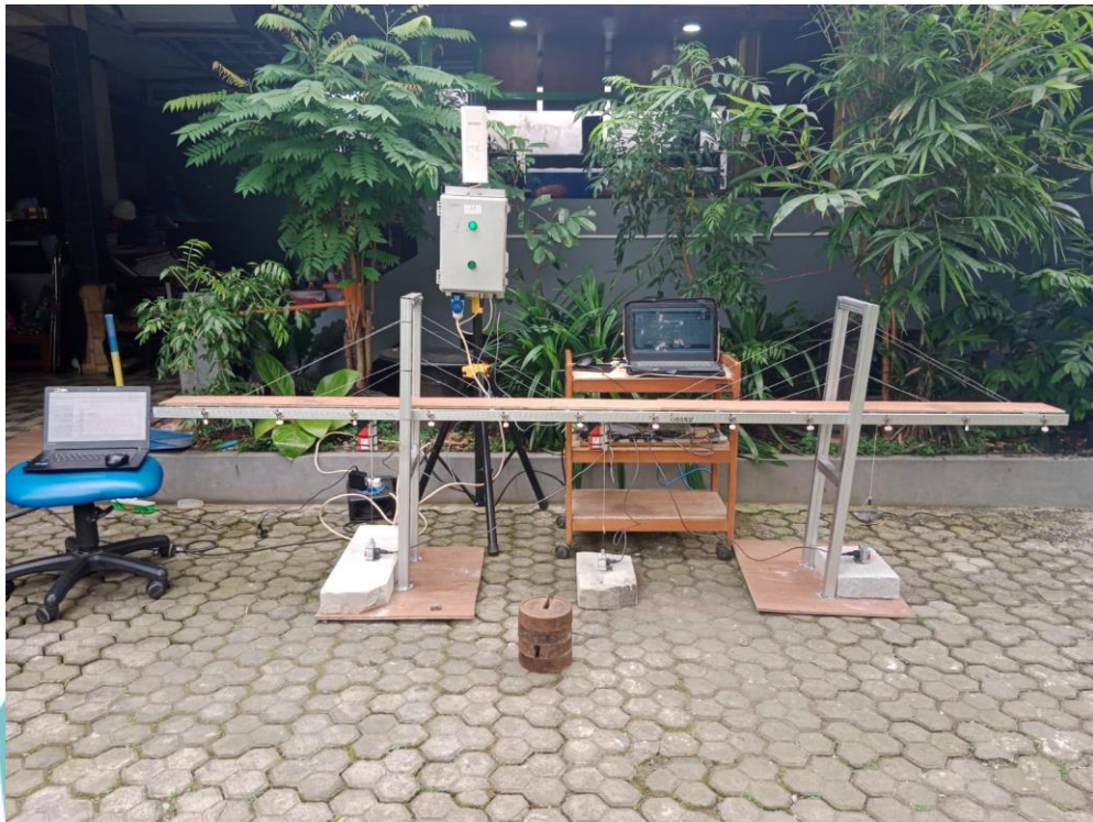
Foto 2. Realisasi Alat Saat Pengujian di Lendutan Jembatan
