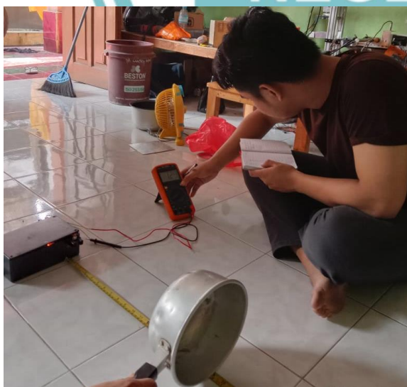
Gambar L-5 Pengujian cara kerja sensor proximity infrared
