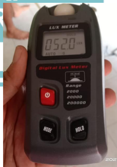
Gambar L-6 pengukuran intensitas cahaya sekitar
