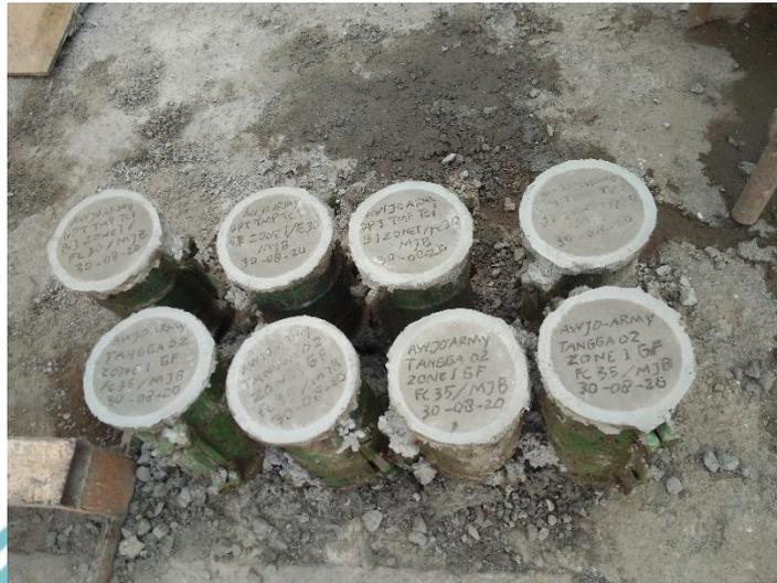
Gambar 5.23 Sampel Beton Untuk Uji Kuat Tekan Beton
