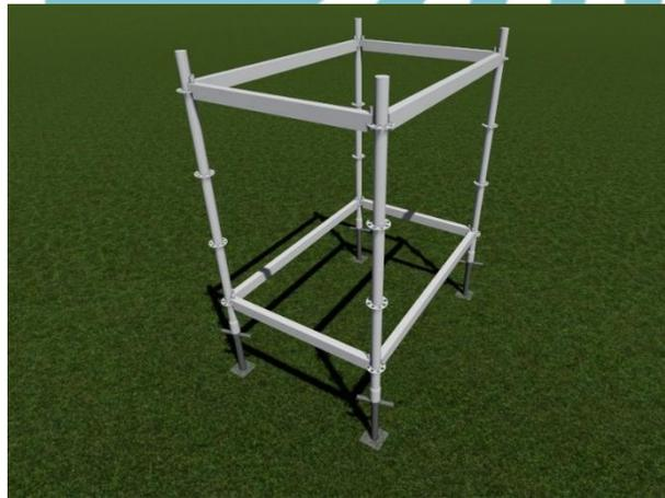
Gambar 5.33 Pemasangan *Ledger Horizontal* Bawah
