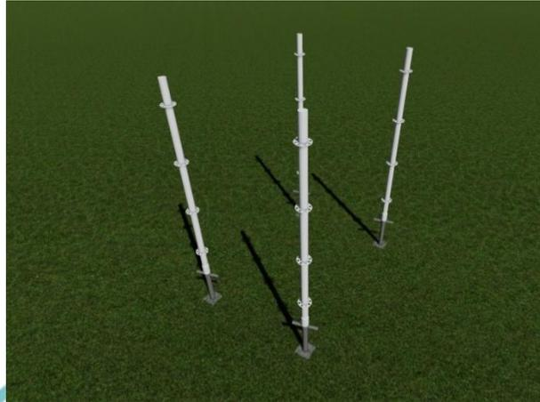
Gambar 5.32 Pemasangan *Standard vertical* Bawah
