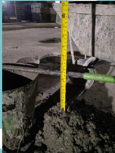
Gambar 5.22 Pengukuran Hasil Uji *Slump* Beton
