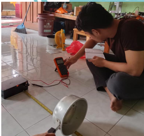
Gambar L-5 Pengujian cara kerja sensor proximity infrared
