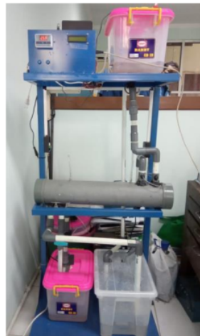
Gambar 2. Sistem data logger yang dipasang pada Prototipe APK shell and tube
