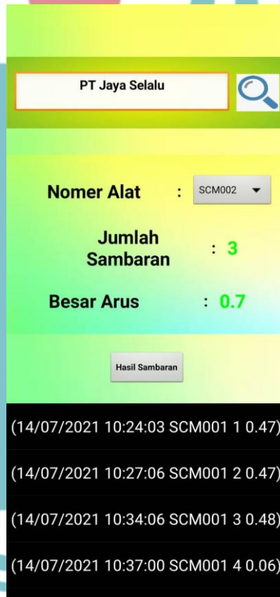
Gambar L.4 Tampilan Aplikasi Android Monitoring Arus Bocor
