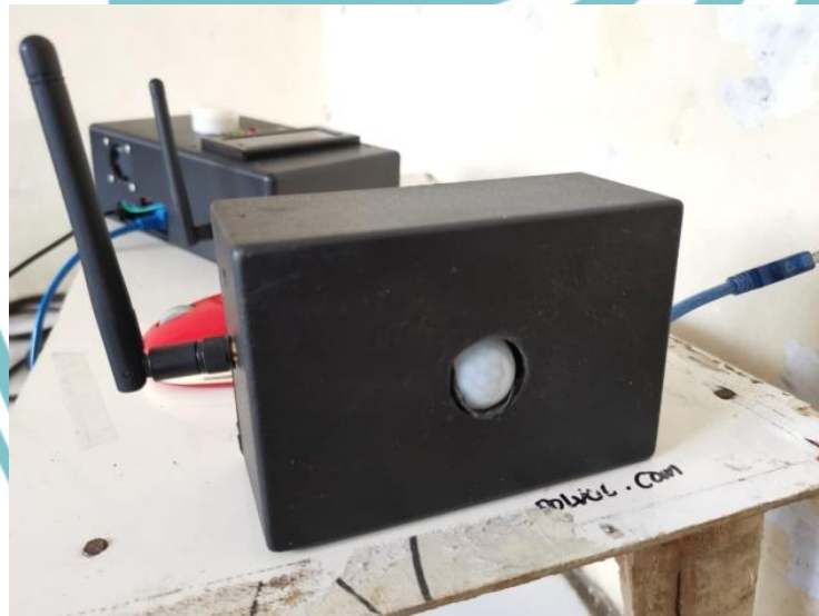
3. Box dengan sensor PIR Dan Arduino Nano
