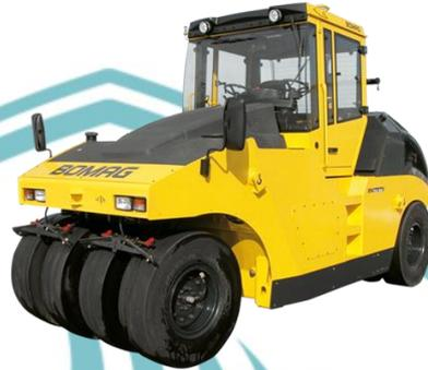
Gambar 3.2 *Pneumatic Tire Roller*
