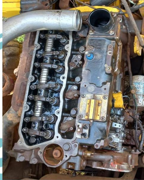
Gambar 3.21 Tempat *Injector* Diberi Penutup
