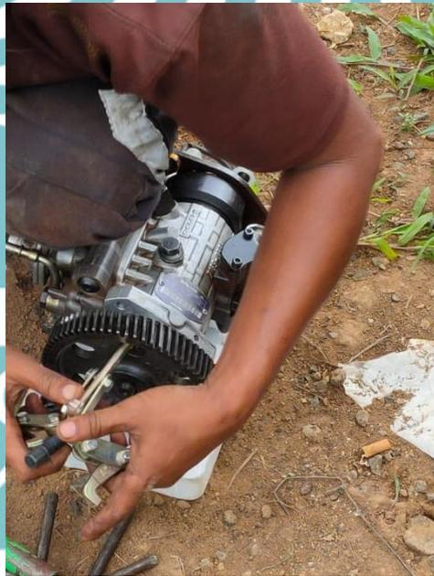
Gambar 3.25 Pemasangan Roda Gigi
