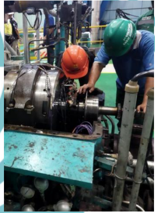
*Kegiatan Pembongkaran House Turbine dan pembukaan Turning Gear
