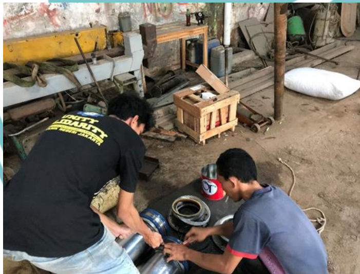
Pelepasan Seal pada Piston Cylinder Dipandu oleh Pengawas Lapangan
