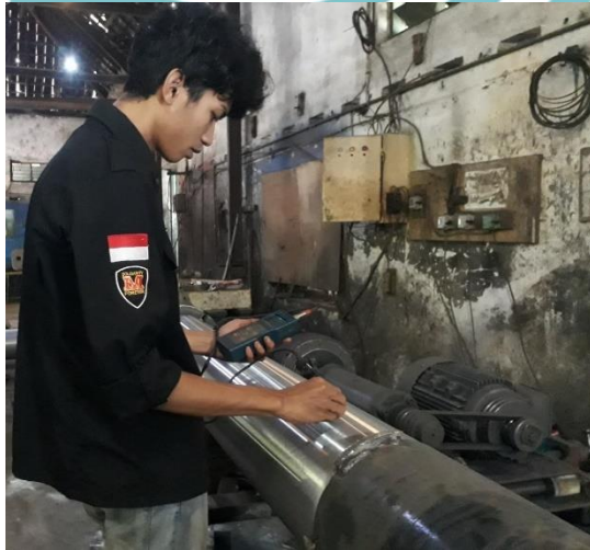
Pengukuran Ketebalan Lapisan Hard Chrome
