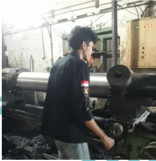
Penggunaan Mesin Bubut saat Pembuatan Hydraulic Cylinder
