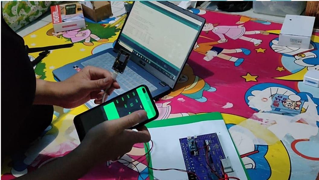
Lampiran 2. Proses memasukan pemrograman ke NodeMCU
