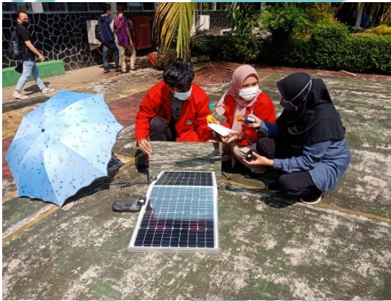
Pengujian modul surya
