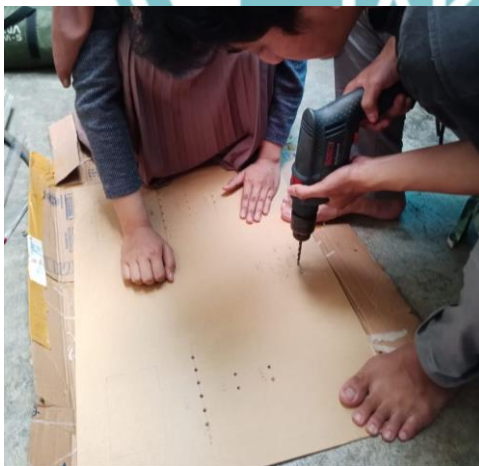
Proses pengeboran papan terminasi untuk instalasi komponen
