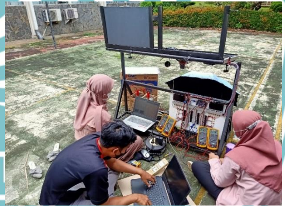
Pengujian PLTS dengan reflektor alumunium dan cermin berbasis LabVIEW
