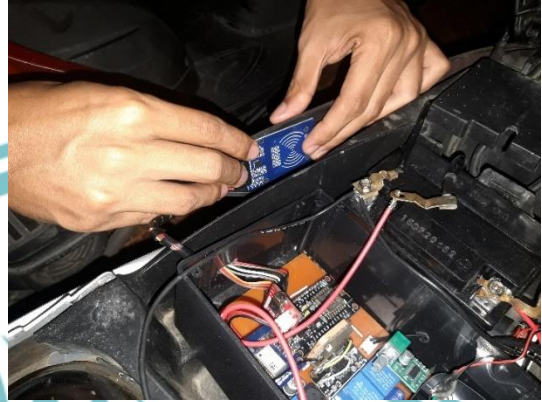
Proses Pemasangan Alat pada Sistem Kelistrikan Motor
