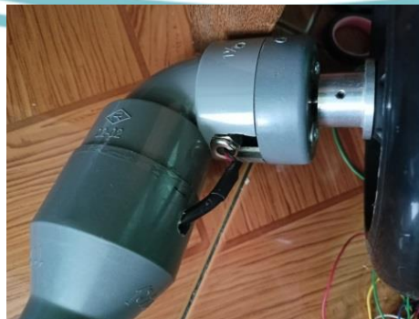
Pemasangan rotary encoder
