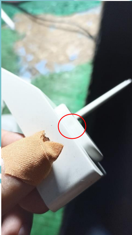
Sink mark pada produk cover key
