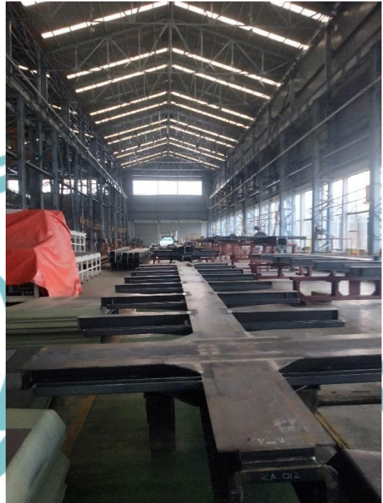
Gambar Lampiran 2 Proses Perakitan Underframe Kereta pada Gedung Perakitan II PT INKA (Persero)
