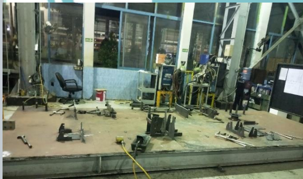
Gambar Lampiran 3 Salah Satu JIG Tipe Datar yang digunakan pada bagian Produksi
