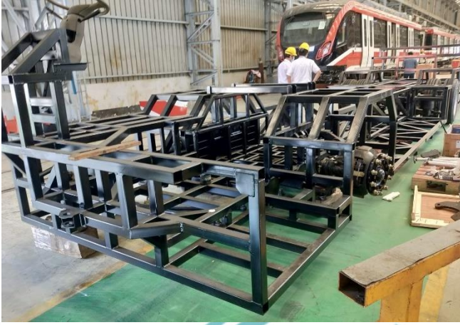
Gambar Lampiran 6 Arrangement Chasis E-BUS 12M Tipe Low-Entry setelah selesai proses produksi
