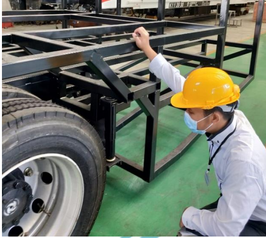
Gambar Lampiran 14 Proses Inspeksi Pemasangan Komponen pada Chasis
