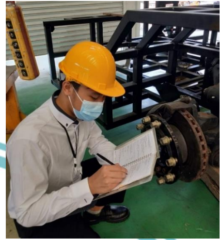
Gambar Lampiran 17 Proses pendataan ukuran Dimensi Pada Chasis setelah selesai proses produksi
