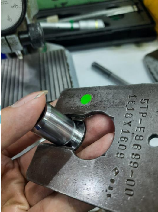
Kegiatan sortir parameter mizo (alur) pada part Boss 1 5TP
