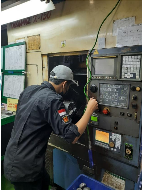
Foto saat melakukan proses setting awal mesin ( dandori )
