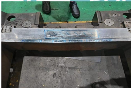
Area NX-4142 yang menghasilkan defect bare
