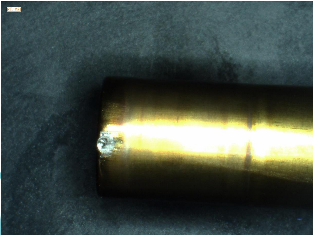
Lampiran 9. Punch pin yang mengalami Fatigue cracking
