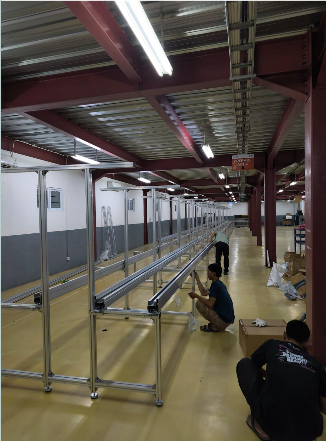
Lampiran 4. Dokumentasi Perakitan Conveyor Assembly
