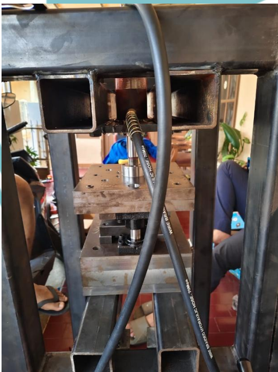
Lampiran 6 Pemasangan dies
