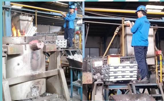
Gambar 3. 7 Pengumpulan Data Temperatur Melting Furnace yang keluar ke area operator
