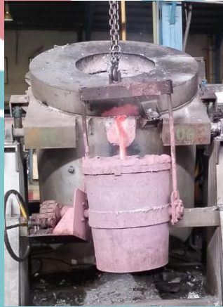
Gambar 2. 4 Melting Furnace pada PT XYZ
