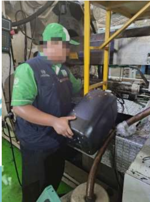
Gambar 1. 1 Pelumasan Oli Manual Kedalam Mesin Injection Molding
