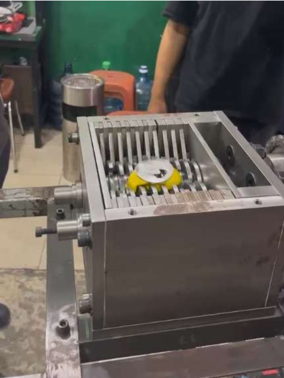
Proses pencacahan kaleng untuk mengetahui kapabilitas shredder box
