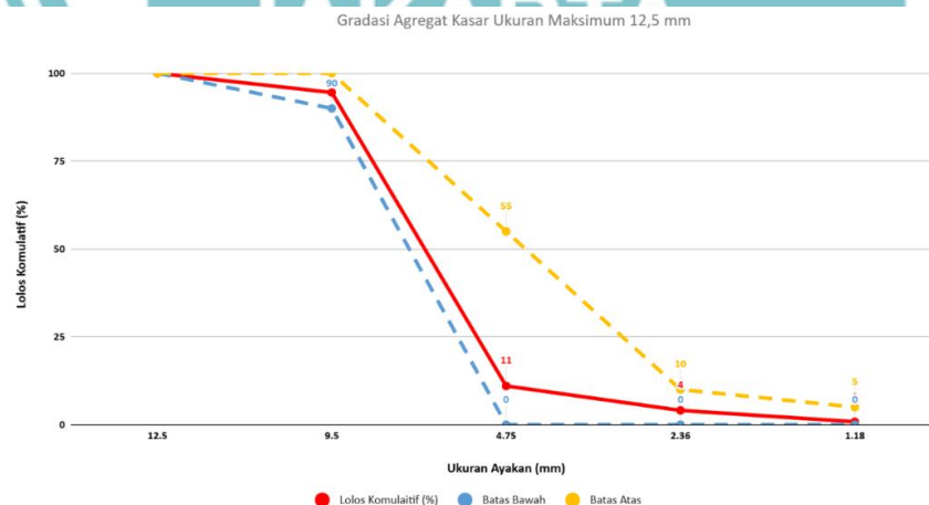
Gambar 4. 1 Grafik Gradasi Agregat Kasar
