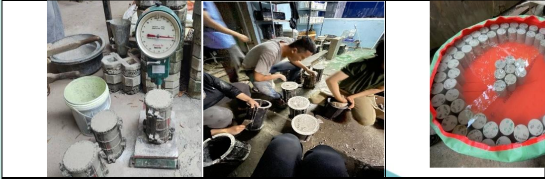
Pengujian Kuat Tekan Beton
