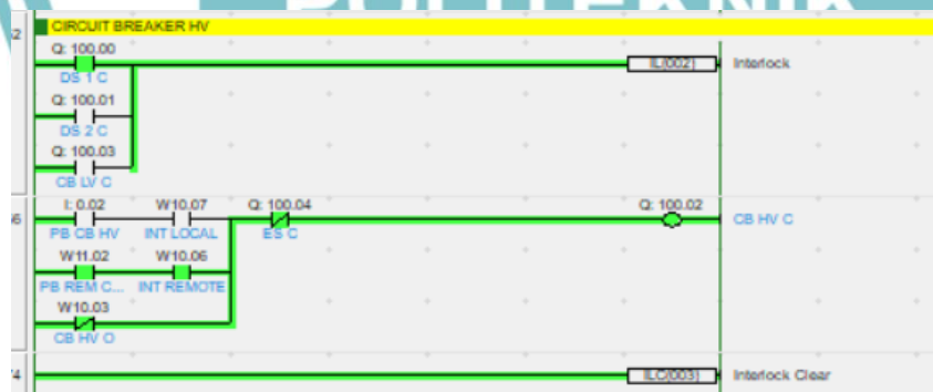
• T-02 (Close CB HV): Alur diagram tangga ( Ladder Diagram ) saat pengujian instruksi penutupan Pemutus Tenaga sisi Tegangan Tinggi ( Circuit Breaker High Voltage Close / CB HV C ) ditunjukkan pada gambar 4.3.
