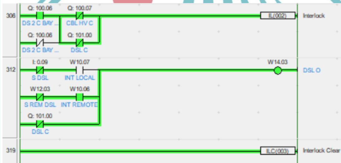
Gambar 4. 21 Hasil Pengujian DS Line Open Bay line
