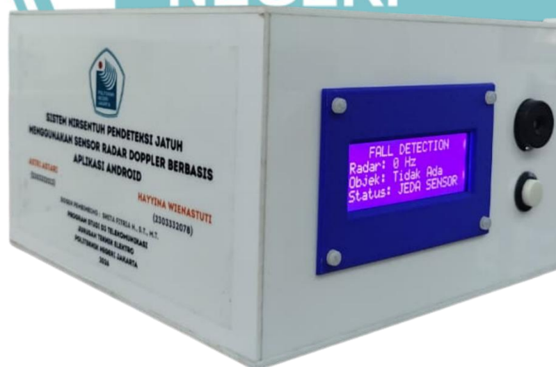
Gambar 3.16 Realisasi Kotak Casing Alat Pendeteksi Jatuh Nirsentuh
