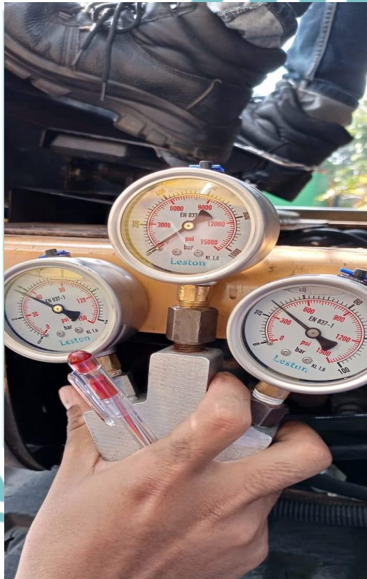
Data actual Pilot System Pressure Test
