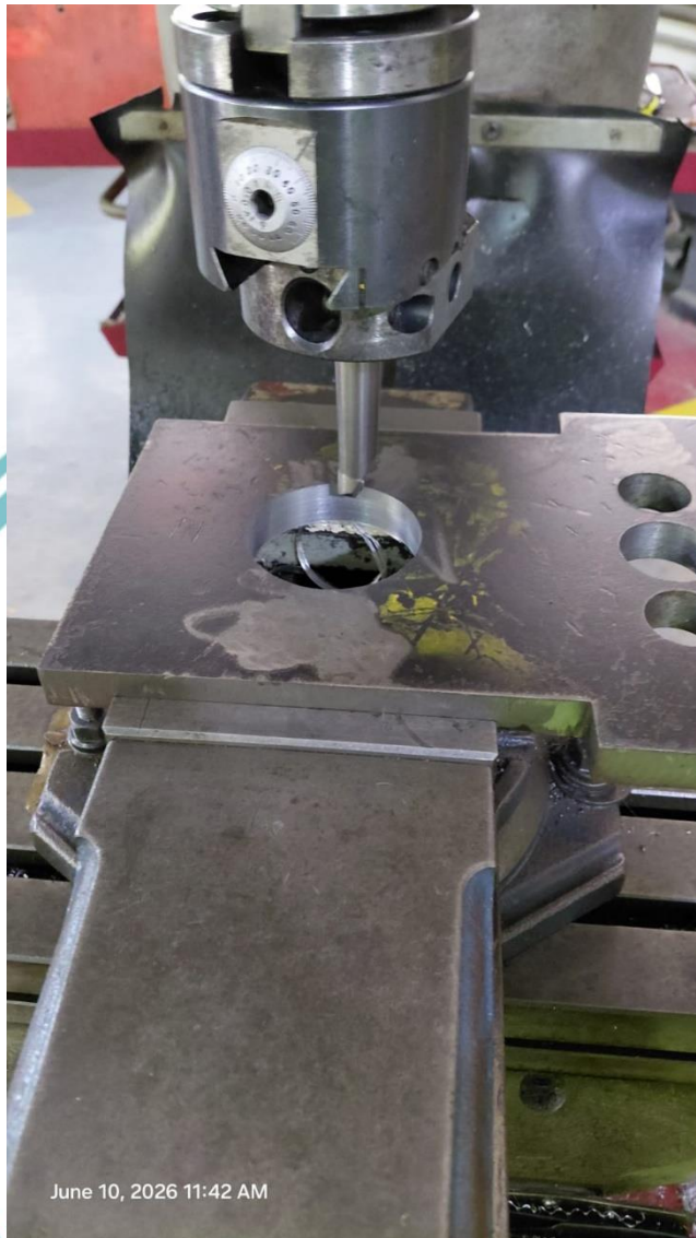
Lampiran 2. 4 Boring hole untuk bracket motor
